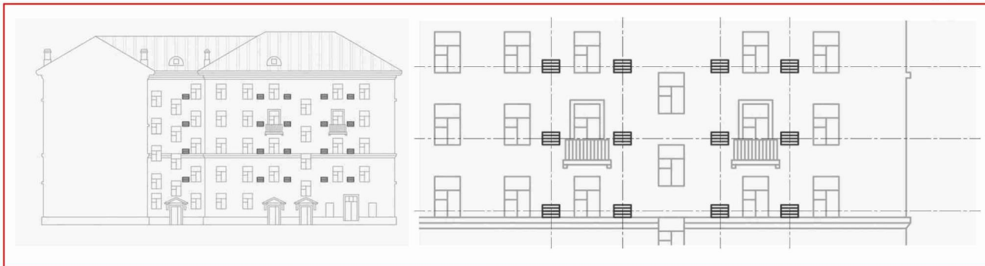
Пример правильного размещения кондиционеров на внутривором фасаде
